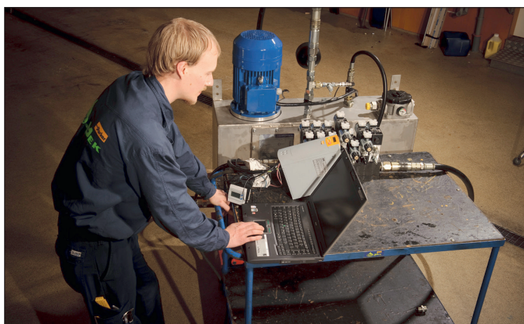
Här programmeras ett Variusaggregat i Oilmeks verkstad.
